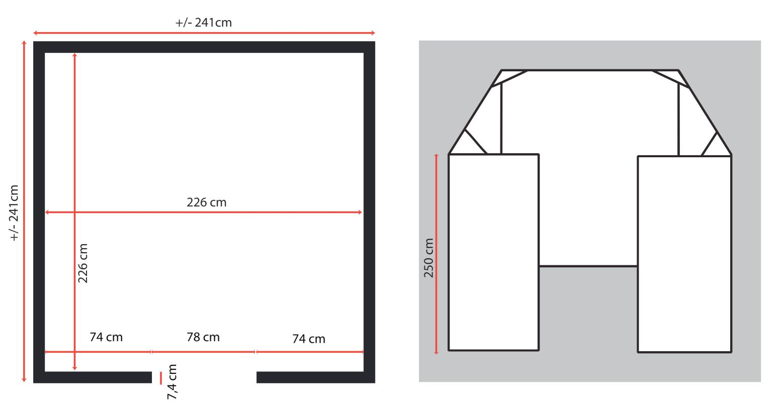
Dimensions intérieures exactes de l'espace : 226 x 226 cm, hauteur : 250 cm. Espace construit en placo-plâtre BA 13 250 x 120 cm, à l'intérieur et à l'extérieur. Murs à peindre parfaitement en blanc mate. Ajouter au dessus 4 équerres de +/- 40 cm pour solidifier les murs aux 4 coins (chutes de mélaminés) sur lesquels installer les spots lumineux.
