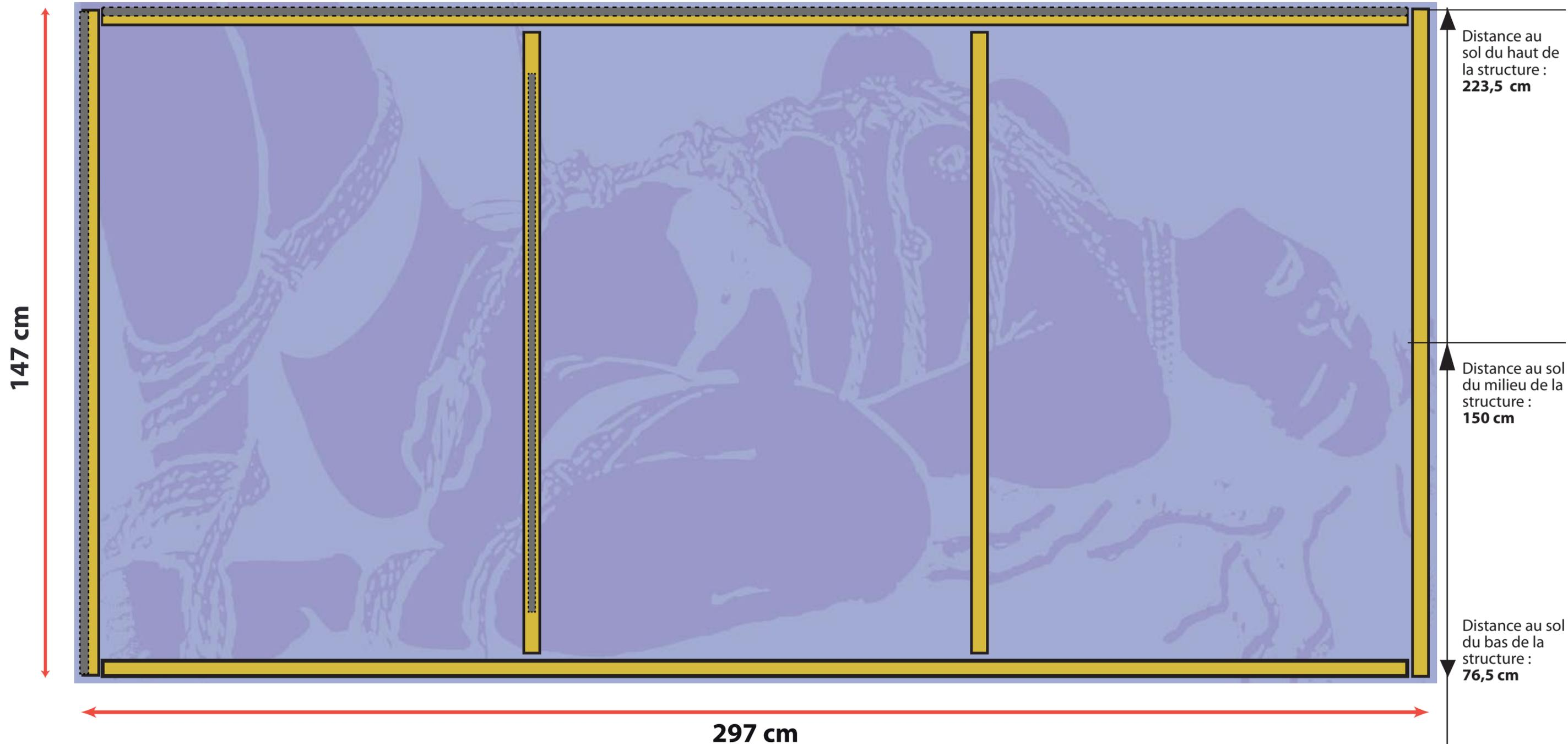
Schéma d'installation de la structure pour installer Bondage & Freedom (fond bleu), 150 x 300 cm. Accrocher le milieu de l'œuvre à 1,50 m de hauteur, l'œuvre dépassera de cette structure de 1,5 cm de chaque côté.
