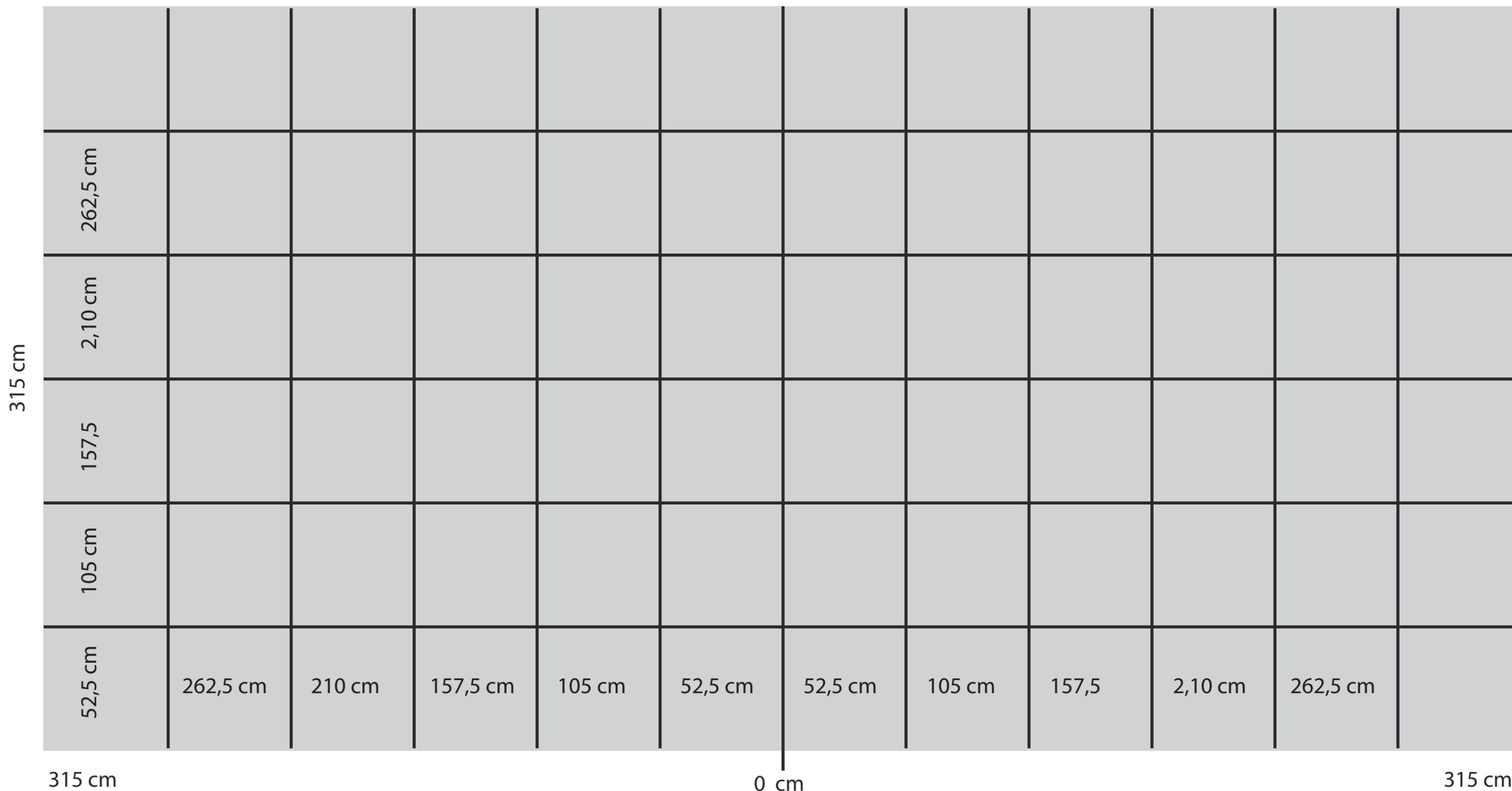
Quadrillage pour placer les bandes de Velcro centrées au milieu des traits : Utiliser un petit marker noir Stanley Fine Tip.
